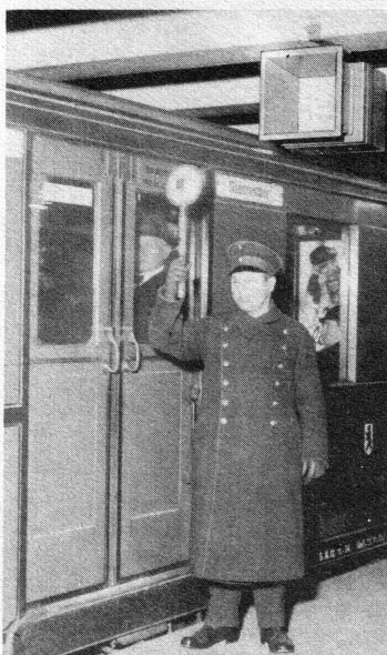
Bild 1. An der Decke hängt der 10-Watt-Lautsprecher, über den dem Publikum Anweisungen und Mitteilungen gegeben werden können. Aufnahme Herrnkind.
